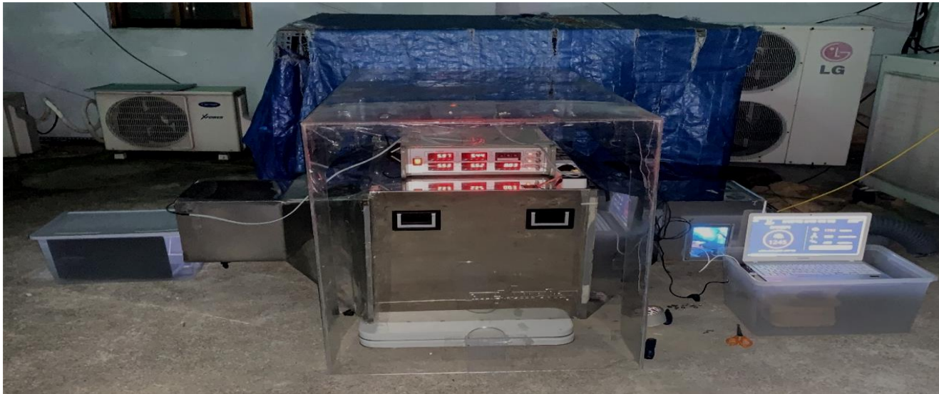
Fig.1 (a) 실험 모식도 (b) 어썬레이의 EUV 기반 집진장비 모델
